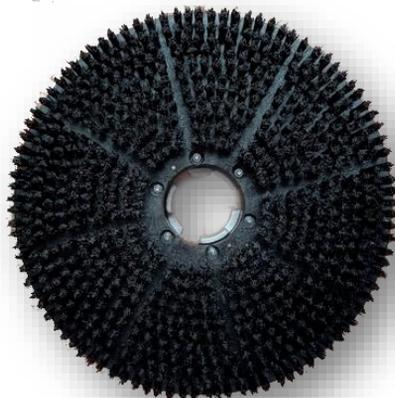
Su **diseño** elimina el hule de la base ahulada y lo **substituye** con una densa cantidad de **fibra de polipropileno** de  $\frac{3}{4}$  de longitud promedio .Se utilizan para **sujetar** discos abrasivos. Proporcionan excelente **sujeción** del disco abrasivo o bonnet (sistema para **limpieza de alfombras**). Cuenta con herraje de aluminio.
